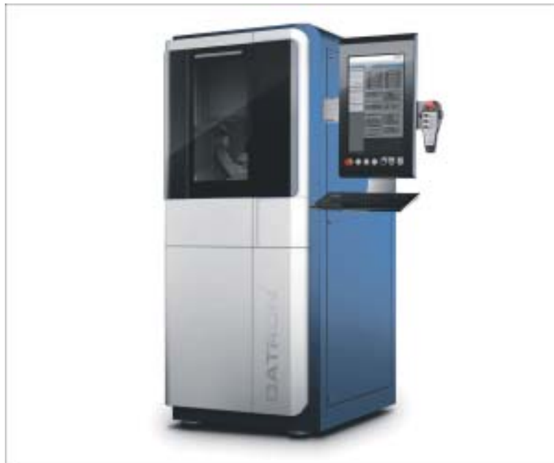
La Datron C5 a été développée spécifiquement pour l'usinage haute précision de pièces pour la micromécanique (jusqu'à 100 mm environ de diamètre).
